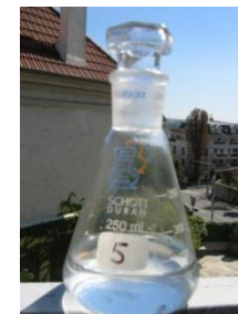
Figure 1 : Fiole contenant une solution étalon
